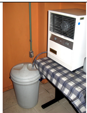
Foto 4 - Desumidificador de ar adaptado com balde de 25 litros
